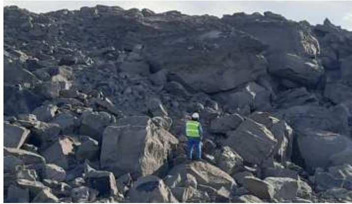
Gambar 3. Material besar ( boulder ) pada bagian atas ( kolom stemming ).
