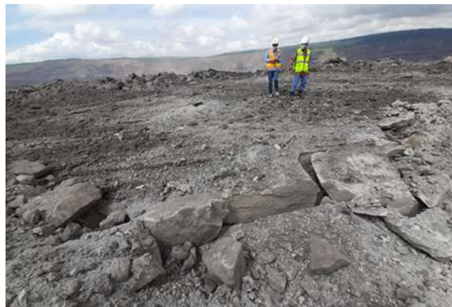
Gambar 2. Permukaan material hasil peledakan yang tampak rata/flat.
