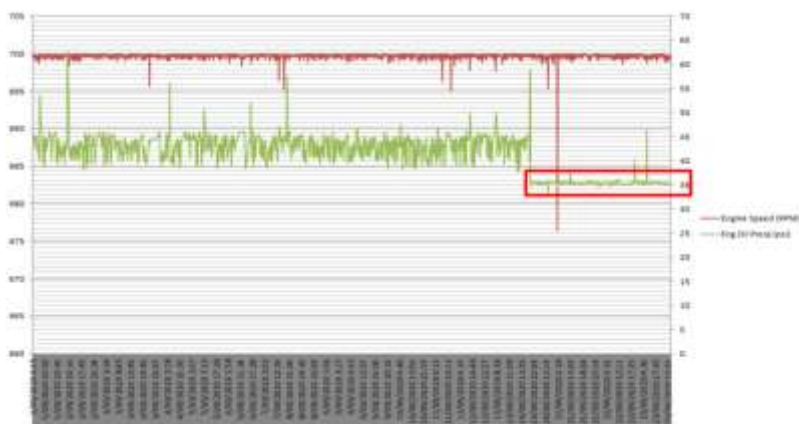
Gambar 5. Engine oil pressure rata-rata menjadi lebih rendah menjelang kerusakan (kotak merah) kondisi engine speed yang rendah
