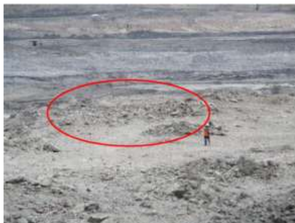
Gambar 5. Dokumentasi Lubang Ledak telah Terinisiasi Sempurna
