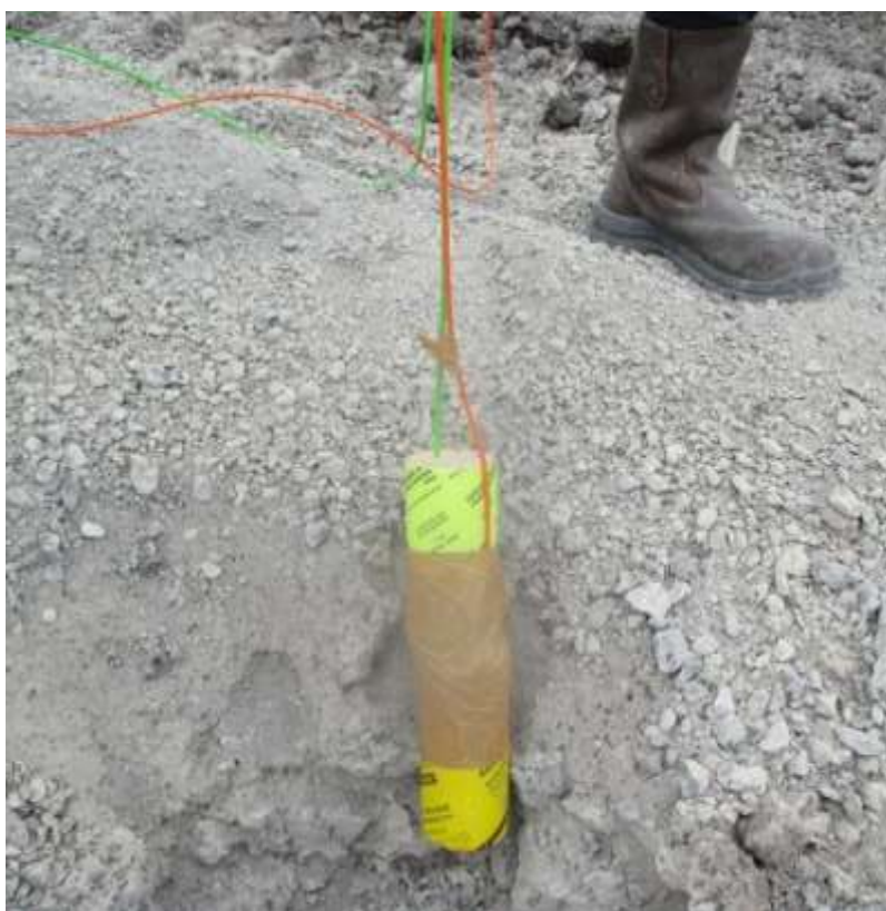
Gambar 6. Dokumentasi Double Initiation pada Elektronik Detonator & Non Elektrik Detonator
