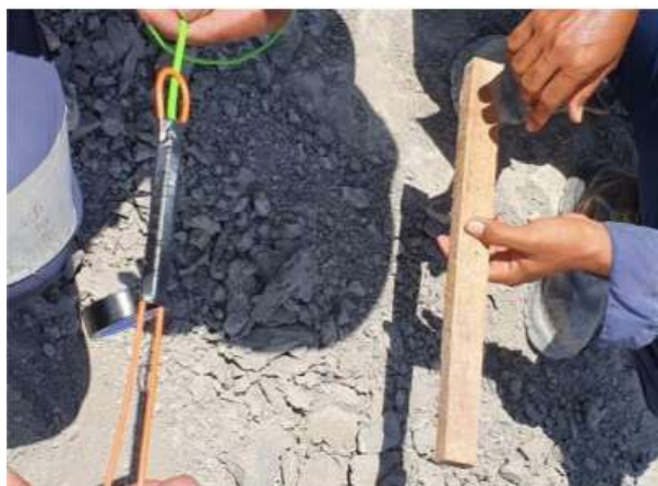
Gambar 11. Perangkaian Inisiasi Non Elektrik Detonator dengan Elektronik Detonator
