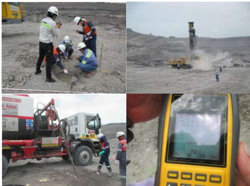
Gambar 3. Proses Penanganan Misfire dengan Sympathetic Detonation
