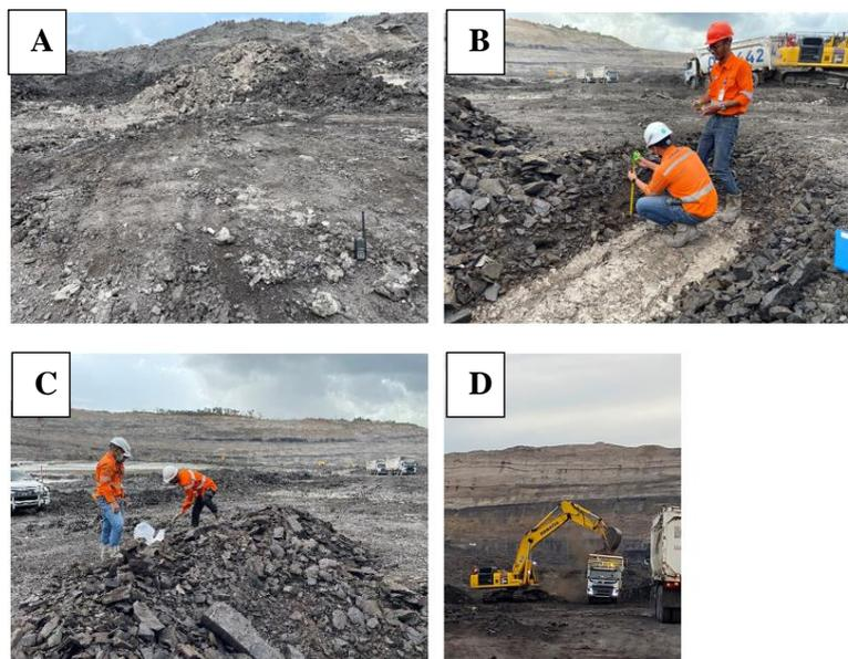
Gambar 5. Area *coal* ekspose yang layak dilakukan pengambilan *sample* (A), Pengukuran ketebalan batubara (B), Proses pengambilan *sample* batubara (C), Proses *Coal Getting* (D)
