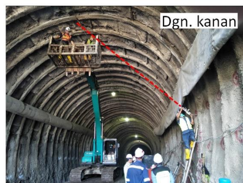
Gambar 4. Dokumentasi kegiatan pengukuran konvergen Terowongan Nanjung
