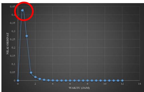
Gambar 9. Hidrograf Debit Air Limpasan Metode Nakayasu DTH 3 Rancangan Geometri Saluran Terbuka
